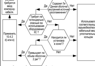
Схема выбора вводов кабелей, которые используются со взрывобезопасными оболочками в соответствии с требованиями EN & IEC 60079-14
